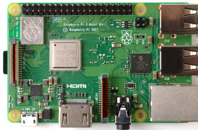
Figura 5: Raspberry Pi 3 modelo B+
